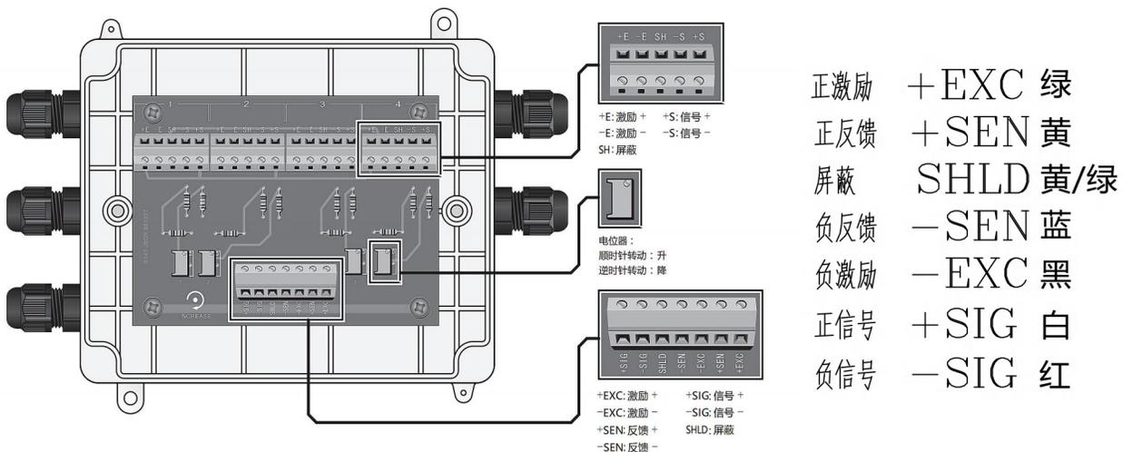
将接线盒固定在秤体的合适位置上，打开接线盒上盖。
